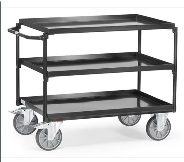
Tischwagen Stahlkonstruktion geschweißbt. Mit 3 Stahlblechwannen. Stahlrohrbügel und Stahlblechwannen verschraubt. Wannen öldicht, Rand 40 mm hoch. Pulverbeschichtet anthrazitgrau RAL 7016. Schiebegriff waagrecht. 2 Lenk- und 2 Bockrollen, TPE-Bereifung, Naben mit Rillenkugellager. Feststeller an den Lenkrollen, gemäß EN 1757-3 (Sicherheit von Plattformwagen). Tragkraft obere und mittlere Ladefläche 200 kg.
