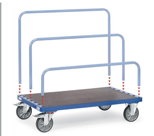
Profilstahl und Stahlrohr geschweißt, pulverbeschichtet, Holzplattform. 7 Verstellmöglichkeiten für Einsteckbügel. Bügelabstand licht 90 mm, 2 Lenk- und 2 Bockrollen, Lenkrollen mit Feststeller gemäß der Europäischen Norm EN 1757-3 (Sicherheit von Plattformwagen). TPE-Bereifung, Naben mit Rillenkugellager. Lieferung ohne Bügel.
