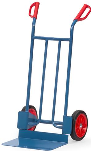
Stahlrohr-Sackkarre mit Stahlblechschaufel, stabile Schweißkonstruktion, pulverbeschichtet, blau, RAL 5007. fetra Sicherheitsgriffe. Stahlblechschaufel anschraubbar und dadurch austauschbar. Räder mit Vollgummibereifung, auf Kunststoff-Felgen, Naben mit Rollenlagerung. Zerlegte Anlieferung.
