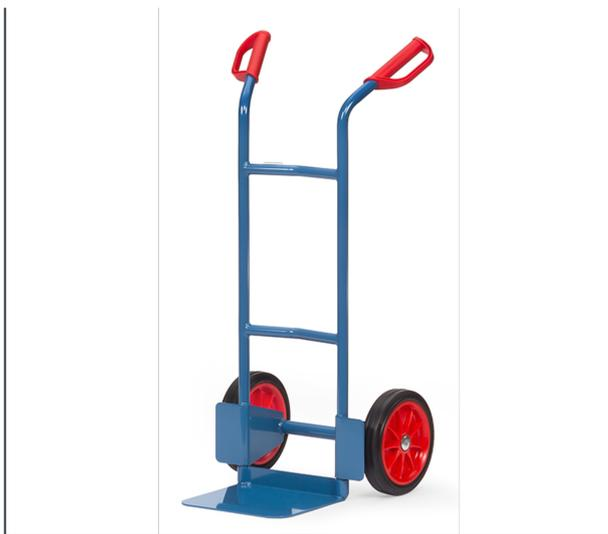
Handlich Stapelkarre mit Stahlblechschaufel, stabile Schweißkonstruktion, pulverbeschichtet blau RAL 5007. fetra Sicherheitsgriffe. Stahlblechschaufel anschraubbar und dadurch austauschbar. Räder mit Vollgummibereifung auf Kunststoff-Felgen, Naben mit Rollenlagerung. Bügel oben und Querstreben durchgebogen. Für den sicheren Transport von runden Gütern, wie Rollen, Kannen, Eimern usw. Zerlegte Anlieferung.
